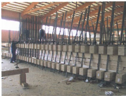
5 Vorfertigung im Werk © Schaffitzel Holzindustrie GmbH & Co. KG
