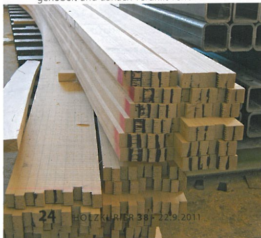
Dauerhaft: Diese Handläufe aus Accoya wurden gehobelt und danach verdrillt verleimt
