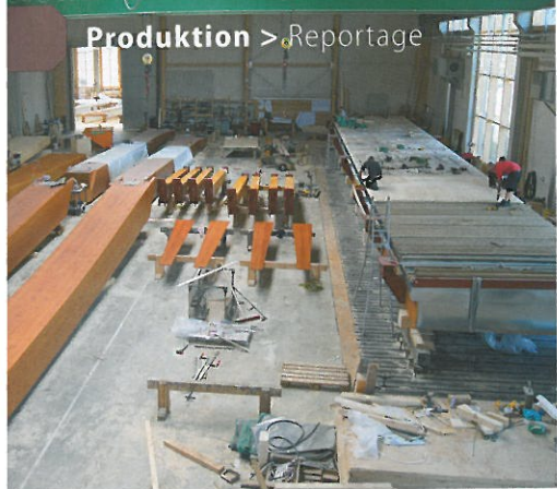
Links liegen die Einzelteile einer Schwerlastbrücke in Holz-Beton-Verbundbauweise, rechts eine Schwerlastbrücke mit 42 t Gewicht
